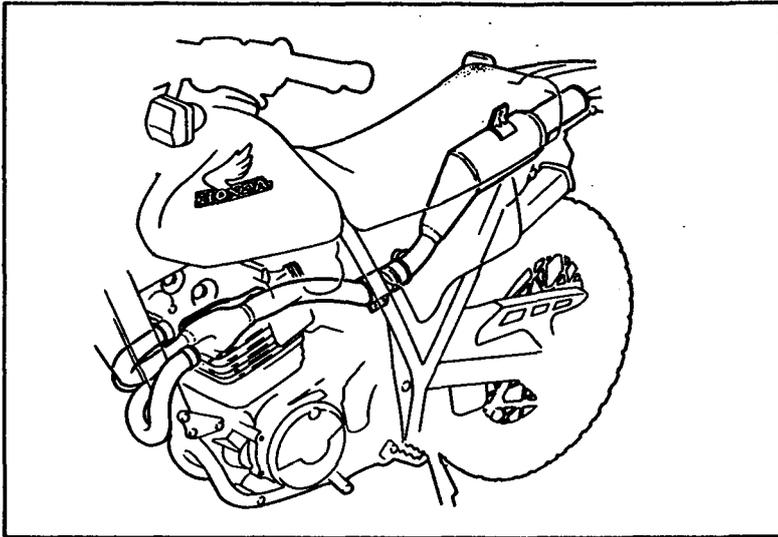
1. Rimuovere il tubo di scarico e il giunto della marmitta.
